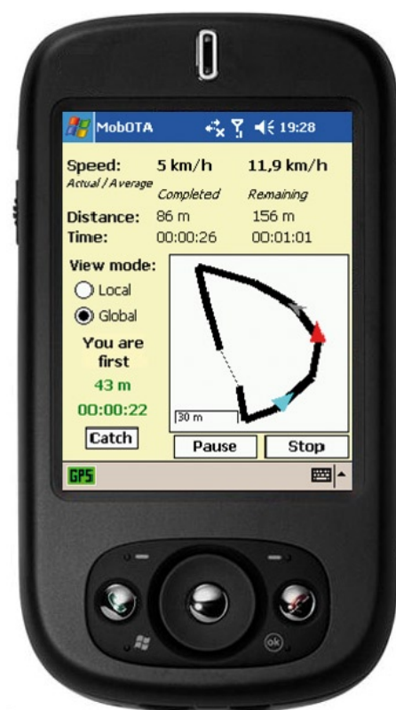
Mobiles GPS-unterstütztes Sportler-PDA: Im Display sieht der Sportler, hier ein Radrennfahrer, seinen Zeit- und Streckenvorteil gegenüber seinen »Konkurrenten«.
